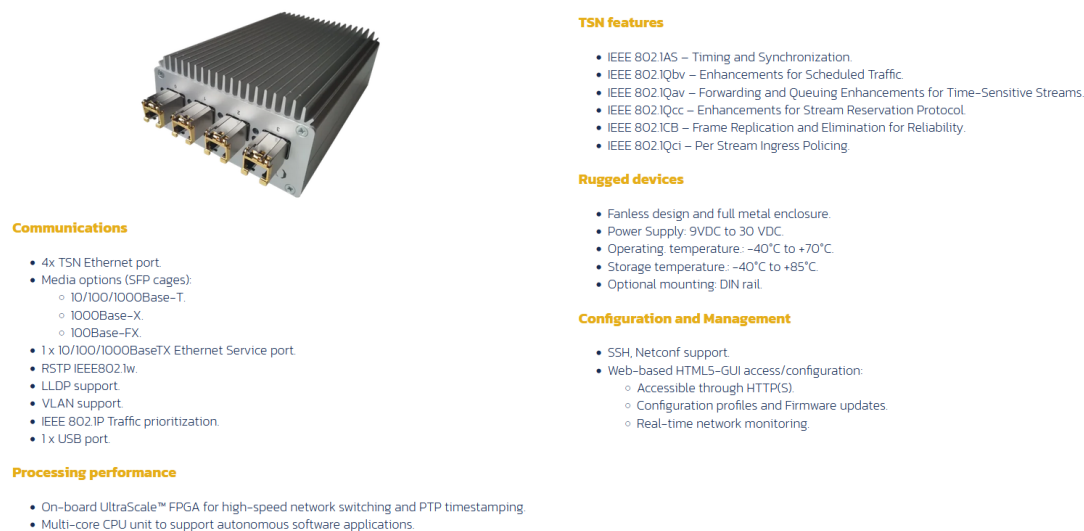
Fig. 4.1. Hoja de especificaciones del RELY TSN BRIDGE 4 [48]
